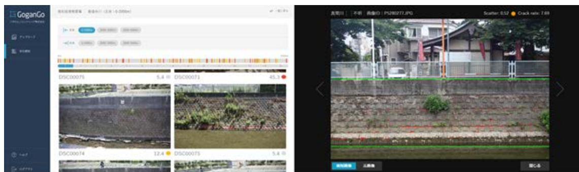
▲「GoganGo」の実際の操作画面（左）と、劣化検知画面（右） ※赤線部分が検知された劣化
